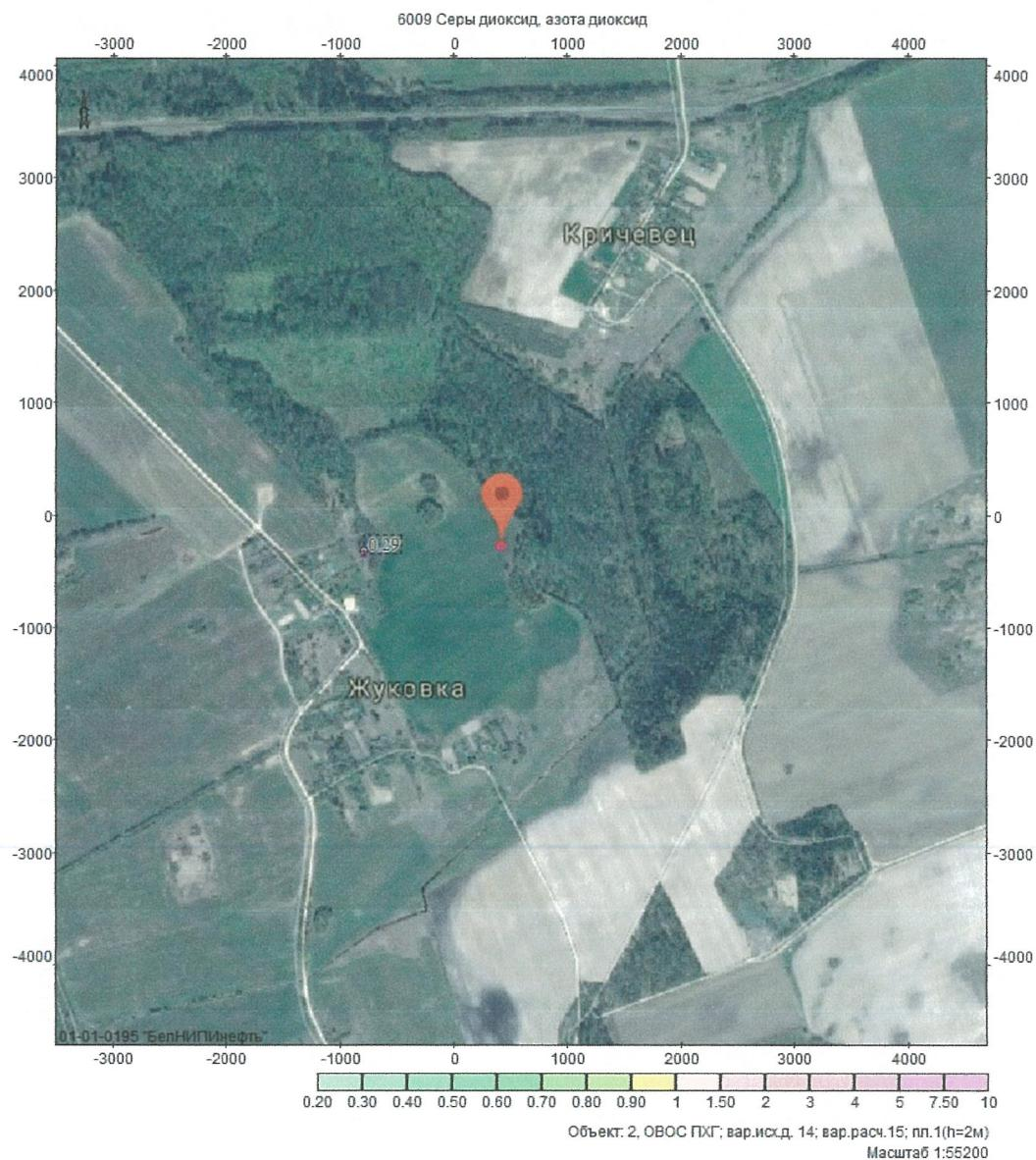
Рисунок 5.2. Зона воздействия по группе суммации: серы диоксид, азота диоксид на период строительства.
