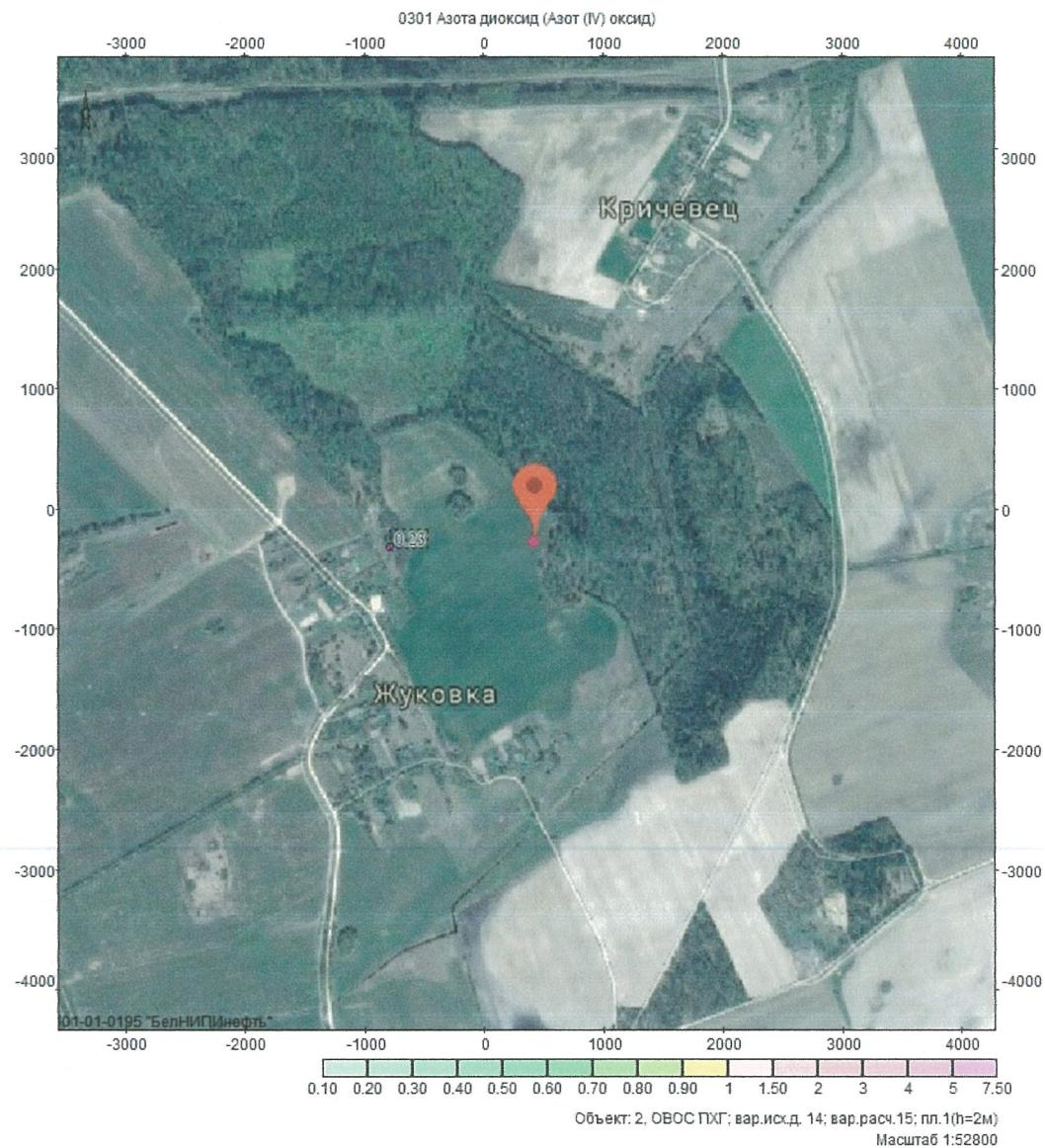
Рисунок 5.1. Зона воздействия по азоту диоксиду на период строительства.
